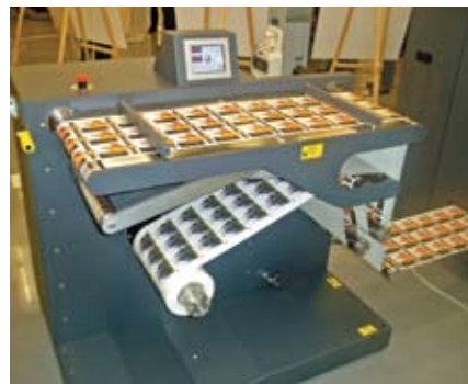
Любому владельцу узкорулонной флексомашины чудом покажется переход на новый заказ без остановки печати. В нижней части снимка на приёмную бобину наматываются последние этикетки предыдущего тиража
