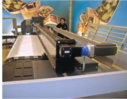
HP Scitex HP2700 — гибридный. При необходимости печати на жёстких материалах достаточно придвинуть столы спереди и сзади (один из них на снимке справа)
