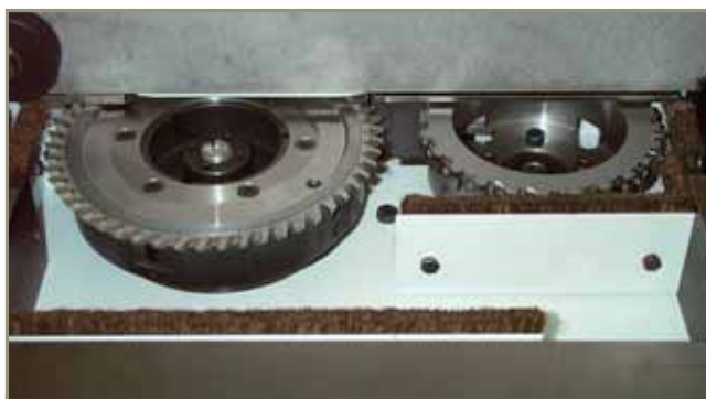
Рис. 3. Двухшпиндельный механизм обработки корешка
